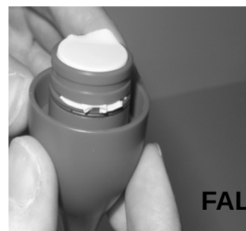
Bild 11: Membran falsch eingesetzt
