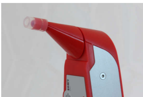
Ilustracja 8: Prawidłowe mocowanie węża silikonowego.
