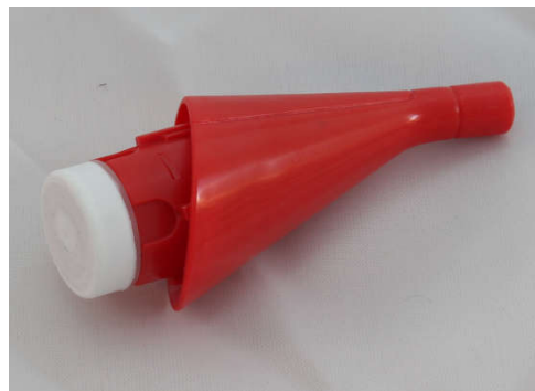
Ilustracja 13: Prawidłowe nałożenie membrany
