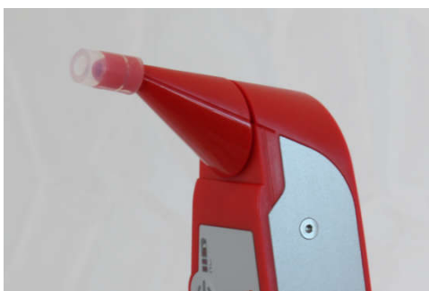
Illustrasjon 6: Korrekt plassering av silikonslangestykket.
