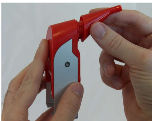
Illustrasjon 13: Påsetting av munnstykket
