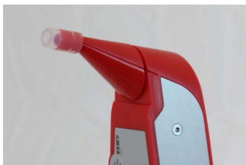
Afbeelding 8: Correcte zitting van de siliconen opzetstuk.
