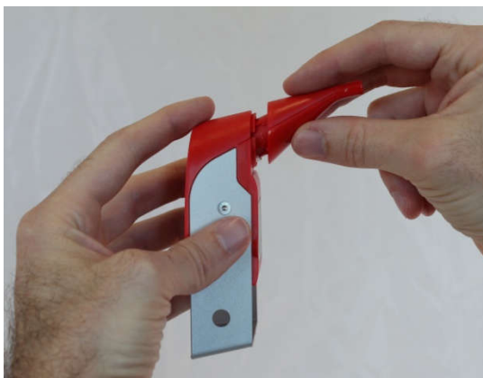
Illustrazione 10: Rimozione del boccaglio
