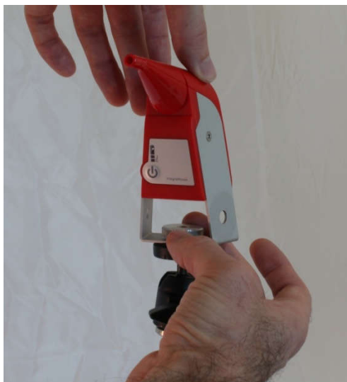
Illustrazione 6: Montaggio di IntegraMouse Plus
