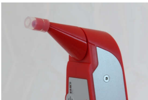
Illustrazione 8: Corretto inserimento del tubicino di silicone.
