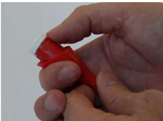
Illustrazione 11: Rimozione della membrana
