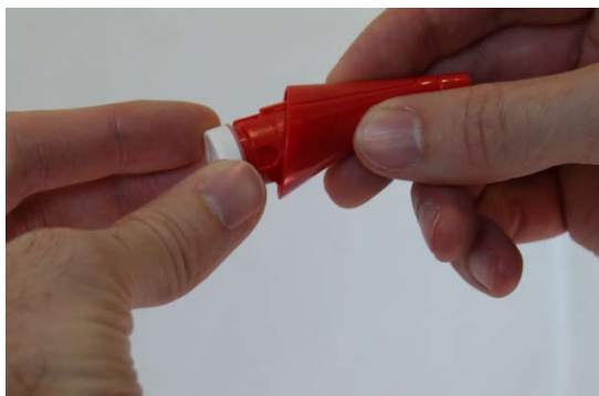
Figure 12 : Mise en place de la membrane
