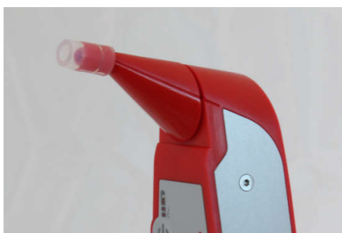
Figure 6 : Position correcte du morceau de tuyau en silicone.
