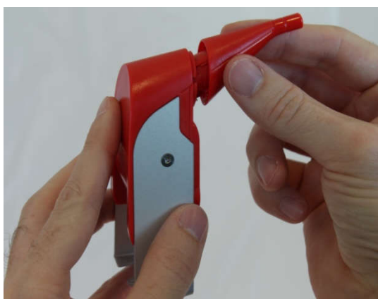
Figure 10 : Mise en place de l'embout
