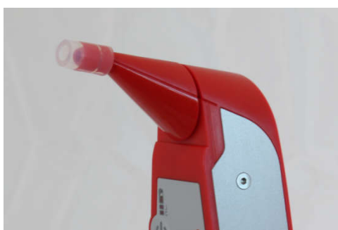
Figura 8: Colocación correcta del tubo de silicona.
