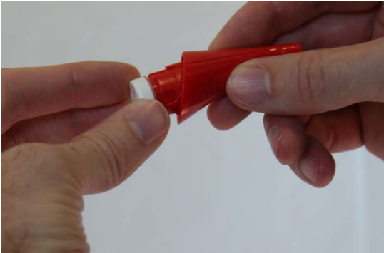
Abbildung 12: Aufstecken der Membran
