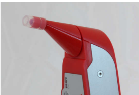
Abbildung 8: Korrekter Sitz des Silikonschlauchstücks.
